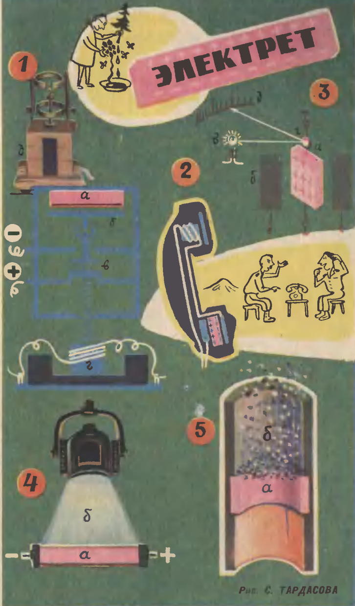
Рис. 1. Схема и внешний вид электростатического генератора: а) электрет; б) диск; в) шины; г) электромагнит; д) внешний вид. Рис. 2. Телефон без источников питания. а) электрет; б) электроды; в) лампочка; г) зеркало; д) шкала. Рис. 4. Фотоэлектрет: а) электрет, б) свет. Рис. 5. Электрет-пылезадерживатель: а) электрет; б) пыль.
